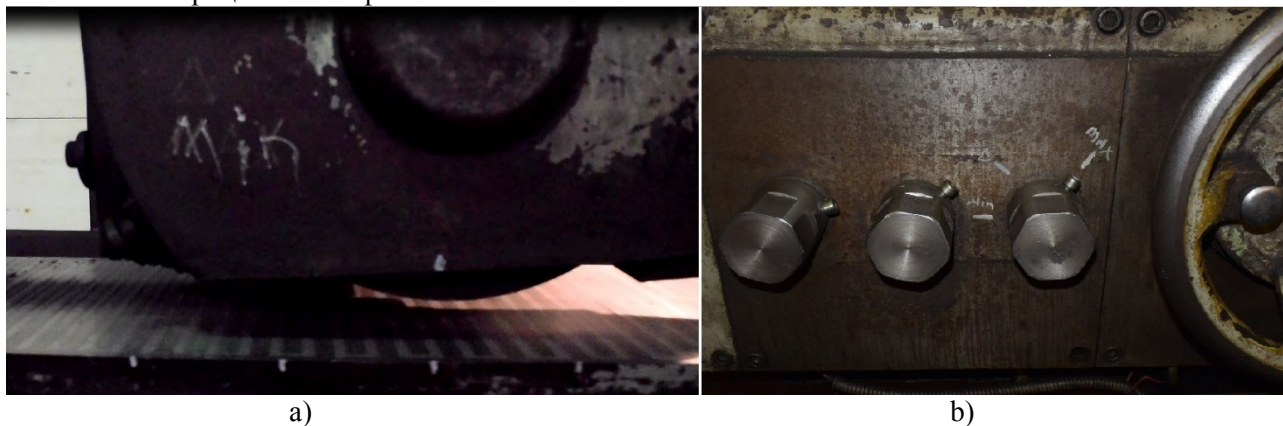
Рис. 1. Разметка оборудования для численного определения значения скорости перемещения стола; а – на кожухе и столе станка; б – на рукоятке дроссельного управления скоростью перемещения стола
