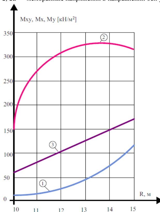
Рис. 7. Зависимость напряжений от изгибающего и крутящего моментов в зависимости от радиуса оболочки при высоте сооружения 5,0 м и опирающегося на четыре свай-опоры: 1 – напряжения от изгибающего момента в направлении оси y ; 2 – напряжения от изгибающего момента в направлении оси x ; 3 – напряжение от крутящего момента
