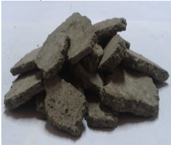
Рис. 1. Форма клинкера, предварительно деформированного в ПВИ
