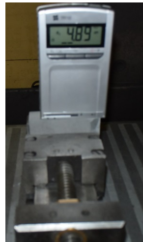
Рис. 2. Измерение шероховатости металлополимерного образца профилометром TR110
